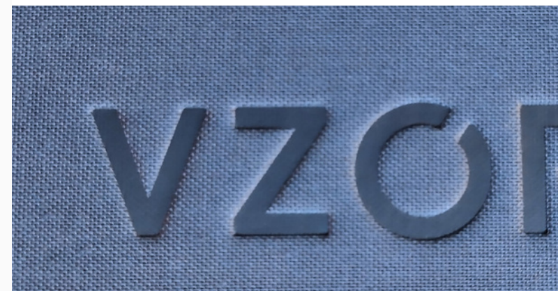
✓ tłoczenie "na sucho"
